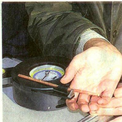
Das Holz aus dem Bohrkern wird auf seine Bruchfestigkeit überprüft.
