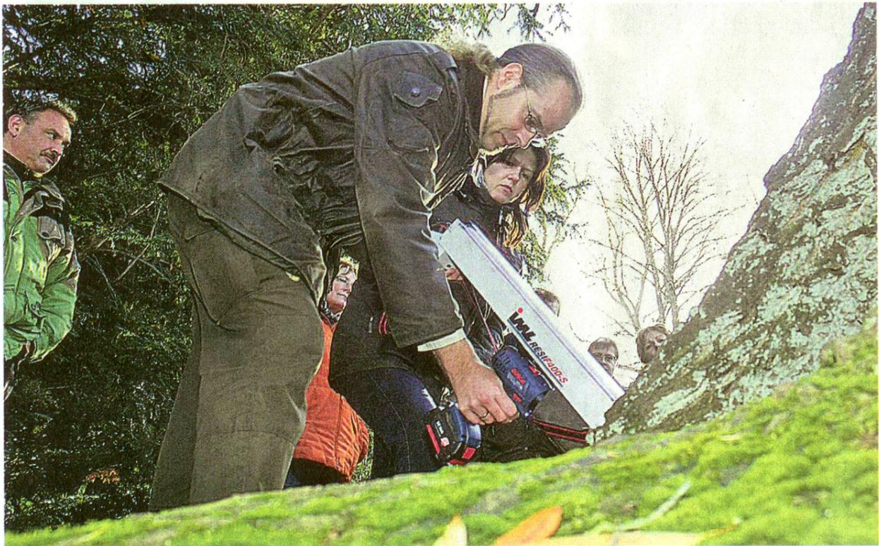
Nicolas A. Klöhn testet mit seinem Messbohrer den Widerstand des Holzes in einer der Wurzeln. FOTOS: THOMAS KLITZSCH
